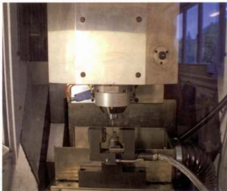
HSC-Fräsen der Elektrode auf Mikron HSM 300 GraphiteMaster mit 27-fach-Werkzeugwechsler
