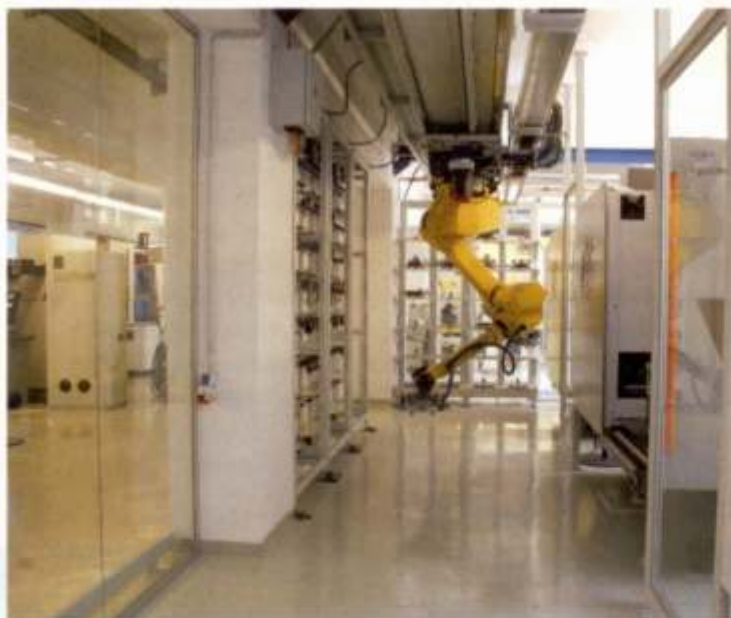
Automation von oben: Der Knickarmroboter von HandlingTech übernimmt das Handling im Inneren der Fertigungszelle, der Boden bleibt frei.
