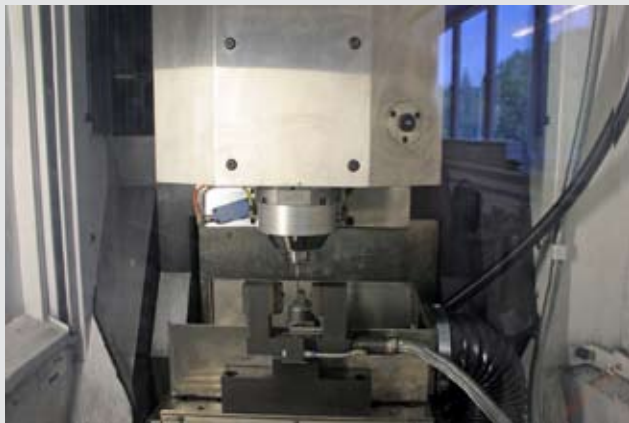
Bild 11: HSC-Fräsen der Elektrode auf Mikron HSM 300 GraphiteMaster mit 27-fach-Werkzeugwechsler
