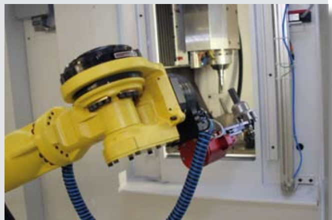
Bild 8: Eingabe Elektrodenrohling in HSC-Fräsmaschine
