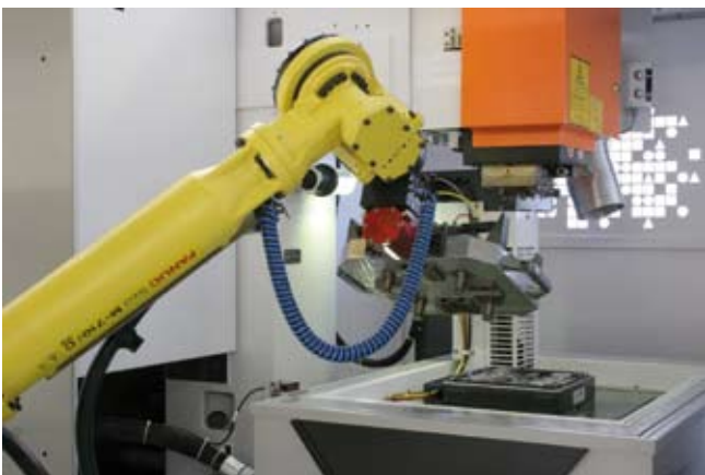
Bild 16: Handhabung der Werkstückpalette an Senkerodiermaschine Agietron Hyperspark 2 HS
