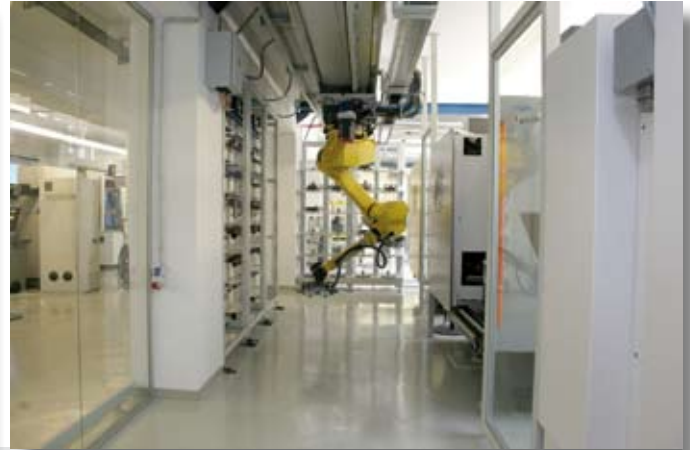
Bild 2: Automation von oben: Knickarmroboter (HandlingTech) im Inneren der Fertigungszelle
