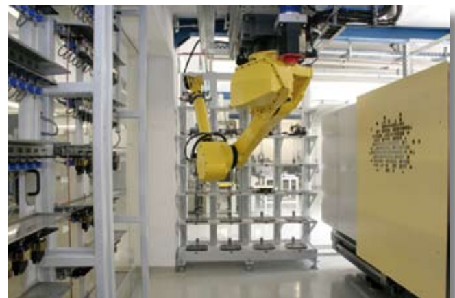
Bild 17: Handhabung der Werkstückpalette an Regalmagazin Paletten
