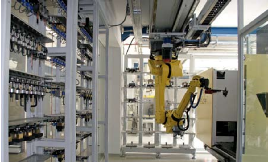
Bild 15: Eingabe einer Elektrode in Senkerodiermaschine Agietron Impact 2
