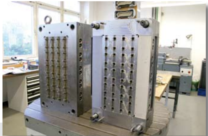
Bild 19: 40-fach-Spritzgießform für Blutlanzzetten (Werkbilder: GFAC, Schorndorf)
