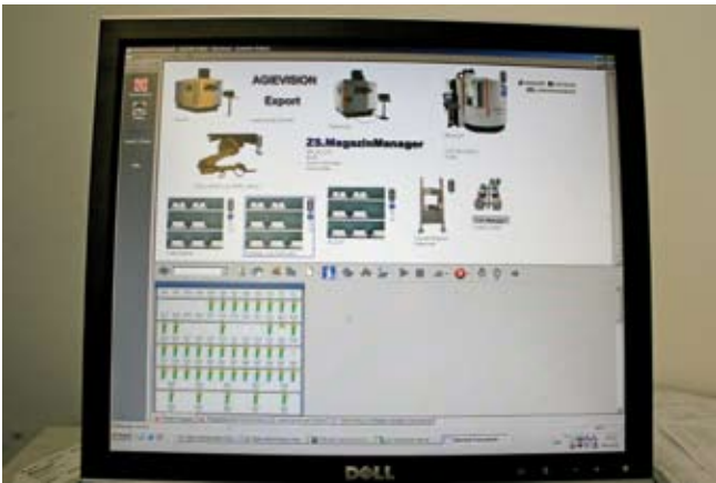
Bild 5: Steuerung der Fertigungszelle mit Zwicker-System-Software
