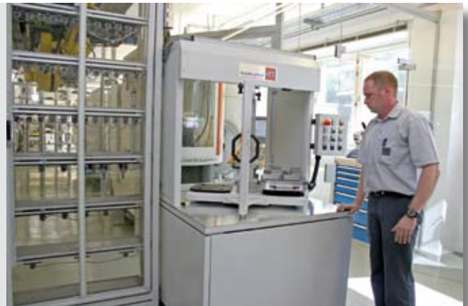
Bild 6: Einschleusen der Werkstückpaletten
